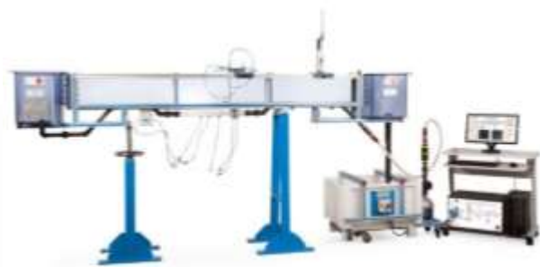
Canal de Fluidos
